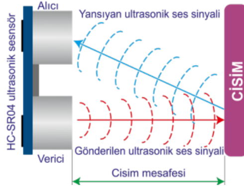
Görsel 4.15: Ultrasonik sensör çalışma prensibi
